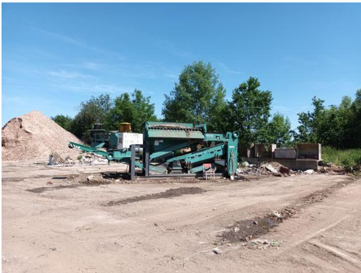
Obrázek 9 – drtička a třídička, využívané pro dřevní odpady i stavební suť a třídění kompostu i recyklátu (zdroj: zpracovatel studie)
