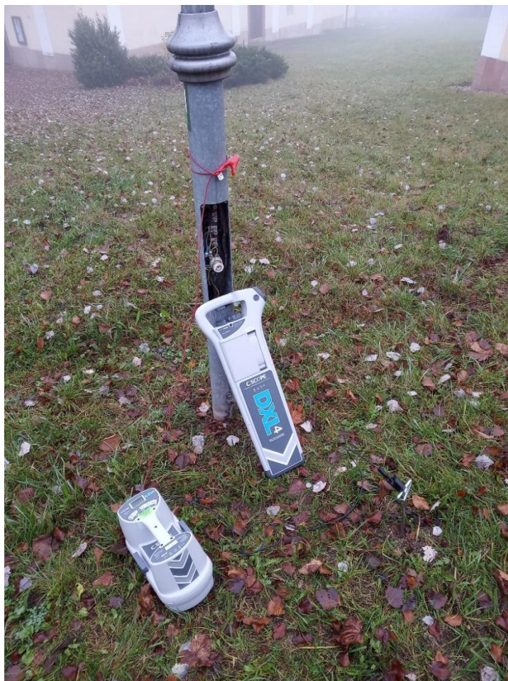
Obr. 3 Určování průběhu kabelového vedení
